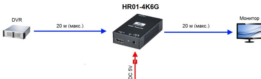
Рис.3 Схема подключения HR01-4K6G
